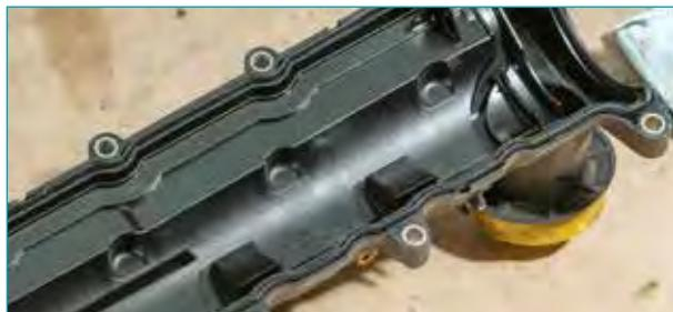
**8.** Завжди встановлюйте суху прокладку, бо використання герметизуючої суміші може привести до видавлювання і протікання, але невелику кількість герметика можна використовувати на закруглених ділянках в зоні розташування підшипника розподільного валу
