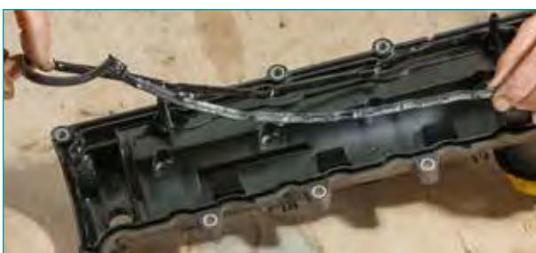
**5.** Після демонтажу прокладки ретельно очистіть прилеглі поверхні та пази, а потім перевірте, чи немає на кришці тріщин або пошкоджень.
