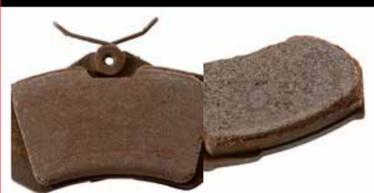
**Внешний вид:** Неравномерный профиль износа колодки.
