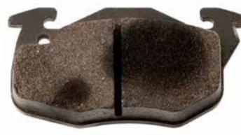
**Внешний вид:** Загрязнение фрикционного материала маслом, смазкой или тормозной жидкостью.
