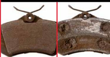
**Внешний вид:** Ржавчина между фрикционным материалом и несущей пластиной колодки.
