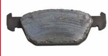
**Внешний вид:** Покрытая «глазурью» рабочая поверхность тормозной колодки.
