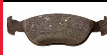
**Внешний вид:** Следы металла на рабочей поверхности колодки.
