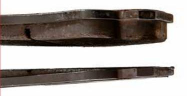
**Внешний вид:** Сильный износ одной или нескольких колодок из комплекта на одной оси.
