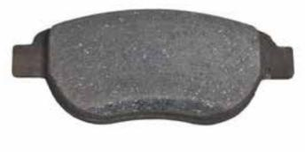
**Внешний вид:** Неравномерный износ поверхности колодки.
