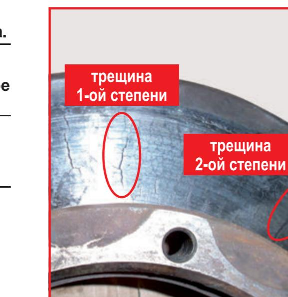
**ВНЕШНИЙ ВИД** Присутствие на поверхности диска трещин 1-ой и 2-ой степеней.
