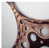
**Причины:** Перегрев приводит к снижению эластичности материала прокладки. Утечки через прокладку происходят в связи с утерей прокладкой эластичности, что не позволяет прокладке сохранять эффективность уплотнения при нагревании и охлаждении двигателя.
