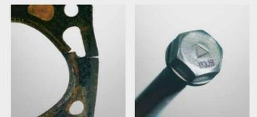
**Признаки:** Смещение материала прокладки, разломы усилительных металлических колец отверстий. Течь прокладки уже после первых тысяч километров пробега.
